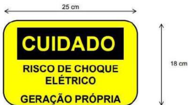
Placa de sinalização fixada junto ao padrão de medição
